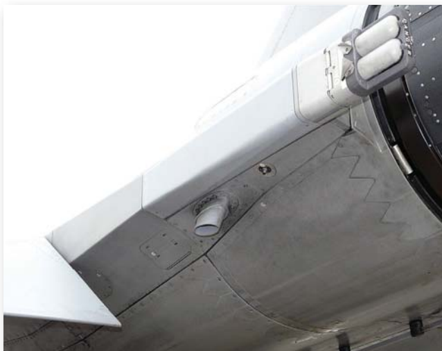
Цик-цак ивице, прејознајљива мера усмеравања радарских зрака, карактеристика су свих авиона са смањеним радарским одразом. На „рафалу“ је та конструкција обилази коришћена око радума, излазних ивица канарда и крила, на убодницима и око издувника, на врашанцима сјајног шраја ...
